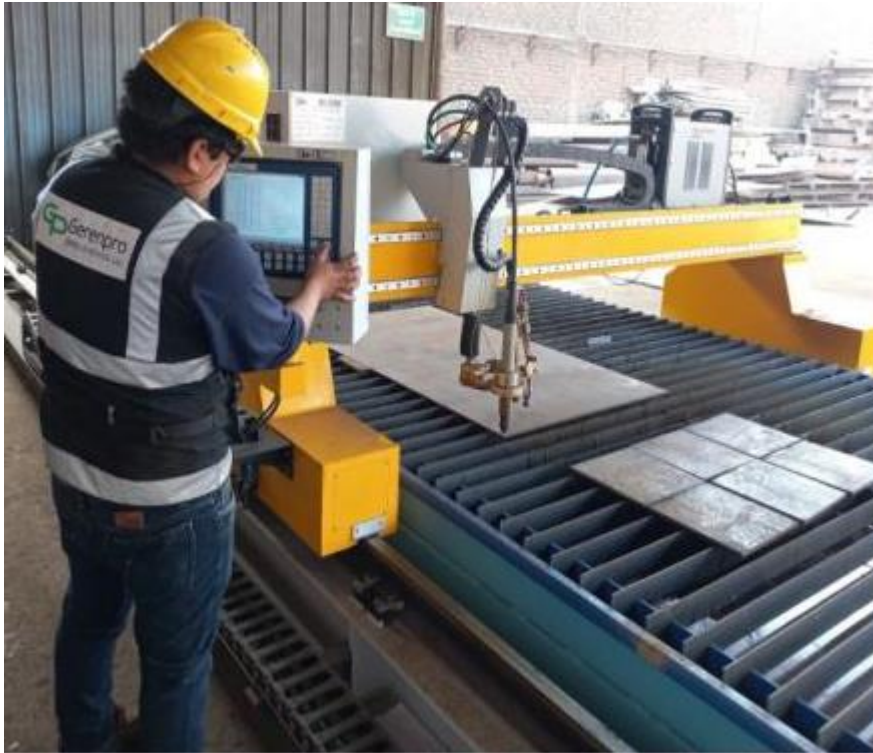
DIMENSIONADO DE PLANCHAS METALICAS EN FASTCAM
